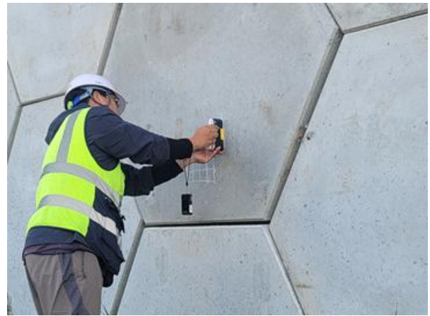
경사계를 이용한 경사도 측정사진
